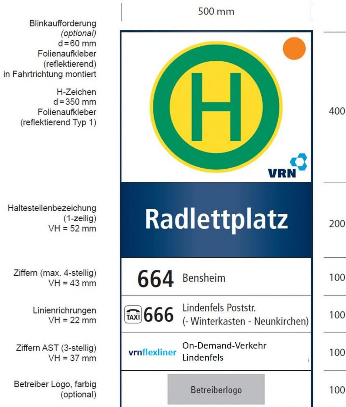
Abbildung 3.2 Wechselschildsystem mit gewölbter Oberfläche als Stele (höherwertiges System)
